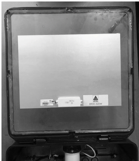
Figure 3 - Panneau LED collé à l'intérieur de la lentille en verre
