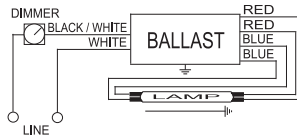
1-Lamp T8 Ballast - Fig. 152
