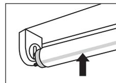
3. Installer les lampes LED (une lampe LED pour chaque lampe fluorescente remplacée et bien s'assurer que les broches soient bien insérées dans les douilles).
