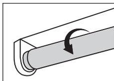
2. Enlever le diffuseur (si applicable), retirer les lampes existantes du luminaire et vérifier que le type du tube remplacé soit bien listé sur l'étiquette du produit.
