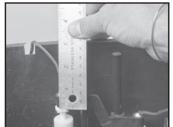
Schalter des oberen Schwimmers im Abstand von 7,60 cm (3") unter dem oberen Rand des Gefäßes
