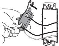
**Tornillos Terminales:** Dele vueltas al tornillo para soltarlo.
