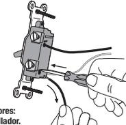
**Conexiones Posteriores:** Coloque el destornillador. Saque el alambre.
